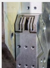
Détail du process électro-érosion sur la pièce
