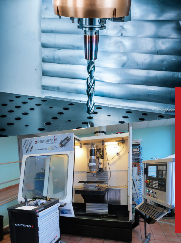
Centre d'usinage CNC Deckel 3 axes 500x500x500
