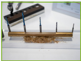
Usinage du laiton sans plomb grâce à des géométries d'outils uniques
