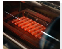
Machine à braser sous vide chez CONCEPT DIAMANT
