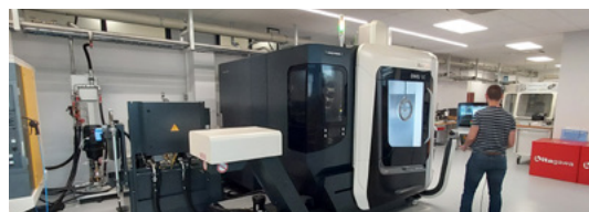
DMG-MORI DMU50 5 axes dans le centre d'essais PRACARTIS Technology
