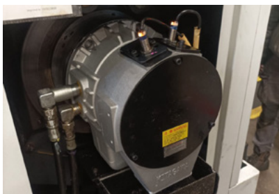
Remplacement d'un pot de serrage KITAGAWA sur un tour DMG MORI NL 2500. Montage sur site par SMG.
