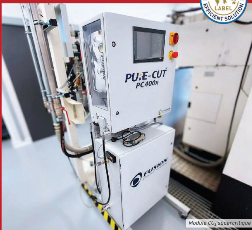
Module CO 2 supercritique intégré à la machine Deckel
